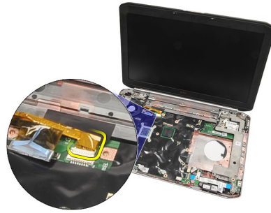
14. اسحب كبلات الهوائي من خلال الفتحة الموجودة في الجزء العلوي من الكمبيوتر.
